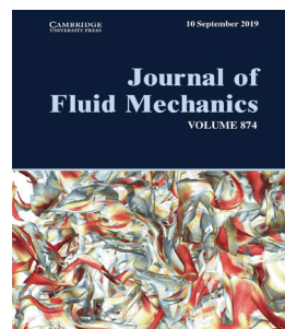
涡面场等值面揭示各向同性湍流中的纠缠涡管结构
